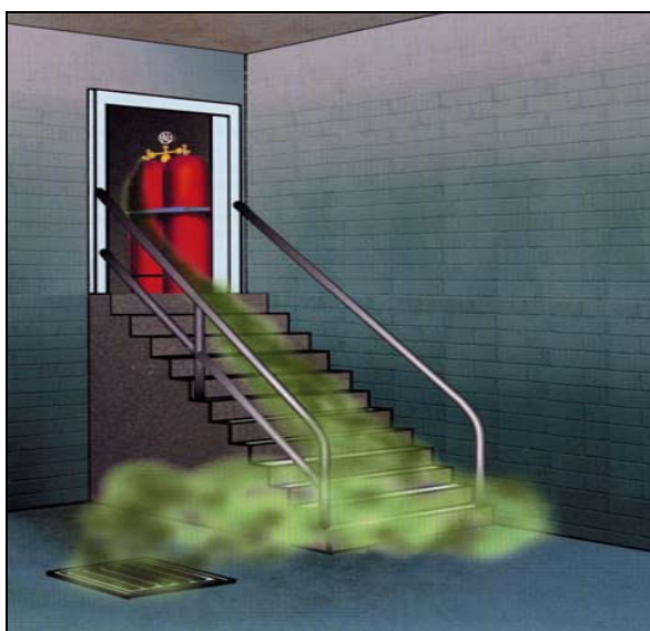
Figura 2.3: Modalità di propagazione dei gas liquefatti (esempio) 4
