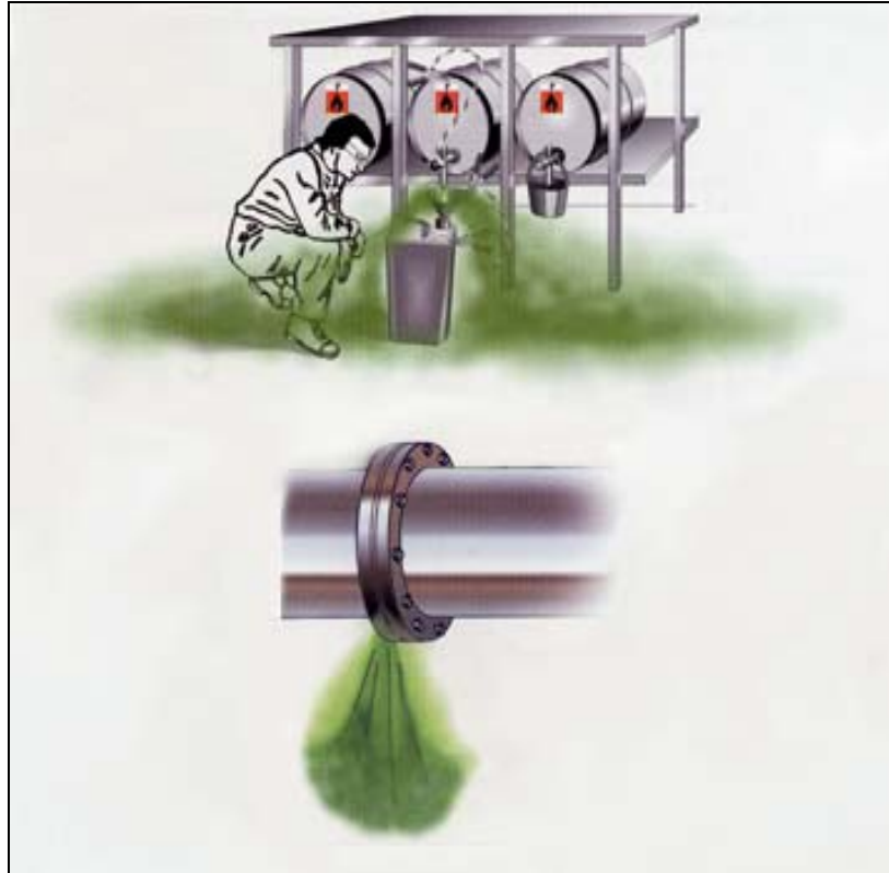
Figura 1: Esempi di come si crea un'atmosfera esplosiva 4 .
