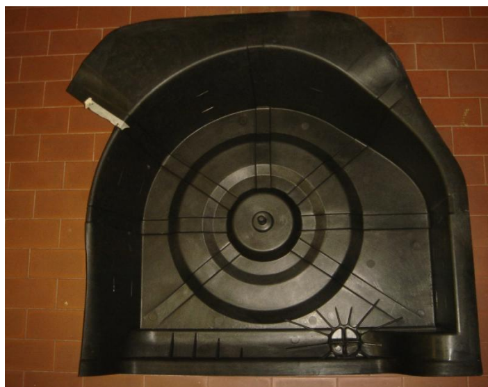
Fig. 7 Alloggio ruota di scorta realizzato in polipropilene nano strutturato (con fillosilicati e agente distaccante)
