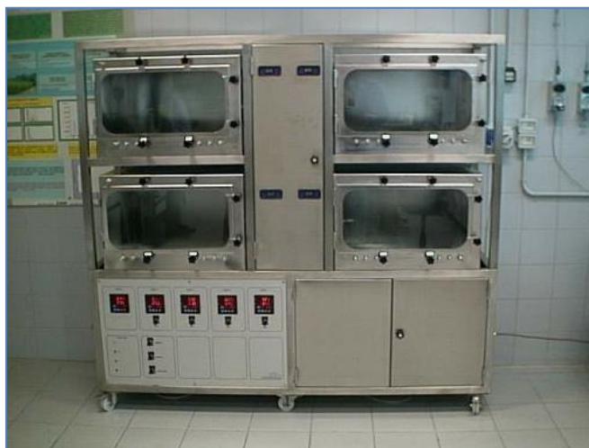
Fig. 6 Camere ambientali all'interno delle quali adesivi, autolivellanti, primers e in generale materiali per l'edilizia vengono analizzati per valutare le emissioni di VOC nell'aria (GEV testing method) al fine del conseguimento della certificazione EMICODE.
