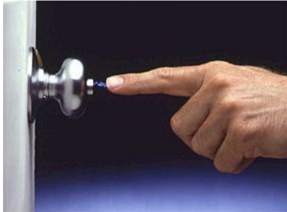
Esempio di scarica da uomo a conduttore
